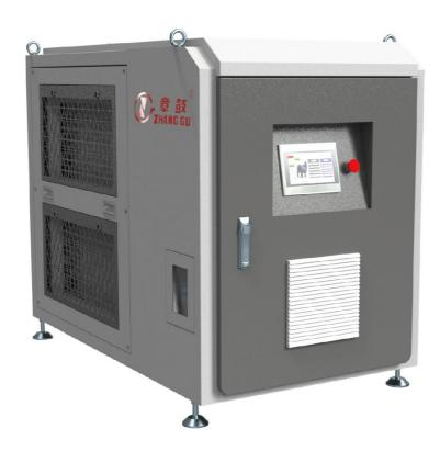
空气悬浮轴承高速离心鼓风机是一种高效节能、 绿色环保的产品,其机械结构简单、运动部件少、 控制鲁棒性好、维护方便。采用车规级无油高可靠 动压空气悬浮轴承,运行过程中无摩擦、机械损失小。 采用先进的永磁同步电机技术, 转速最高可达 95000rpm, 仅需 5s 可满转速运行。电机效率高达 97%,达到双一级能效标准。
