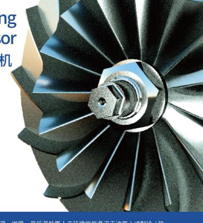
ECC(Environment Control Compressor)是应用于制冷、空调、供暖、高低温舱等人工环境的气悬浮无油离心式制冷 / 热泵压缩机。ECC 压缩机采用动压气浮轴承、高效气动设计、高效永磁电机、智能控制等独特技术,使 ECC 系列产品不仅具备节能、环保优势,而且具备无油、高可靠、免维护、低振低噪等突出特点。
