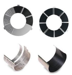
空气悬浮轴承在启动前转子和轴承之间有物理 性的接触, 启动时转子和轴承相对运动产生空气 压力, 转子旋转的时候, 转子周围空气的速度能 转变成压力能,在转子达到一定的回转速度时空 气压力使得转子浮起,并起到润滑作用。
